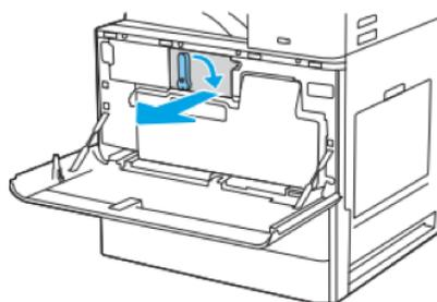
3. Extraiga el cartucho de tóner nuevo del embalaje. Guarde todos los materiales de embalaje para el reciclado del cartucho de tóner usado.
